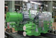
Bomba de alimentación de alta presión para desalinización por Osmosis Inversa en Australia
