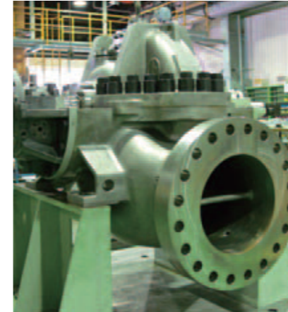
Bomba de alta presión para planta desalinizadora de OI en Arabia Saudí
