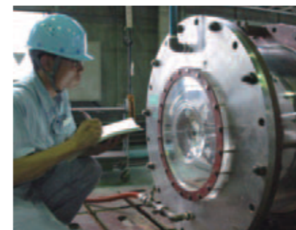
Una prueba visual para la reducción de la fuerza de cavitación
